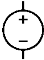
Simbolo di un generatore di tensione ideale
